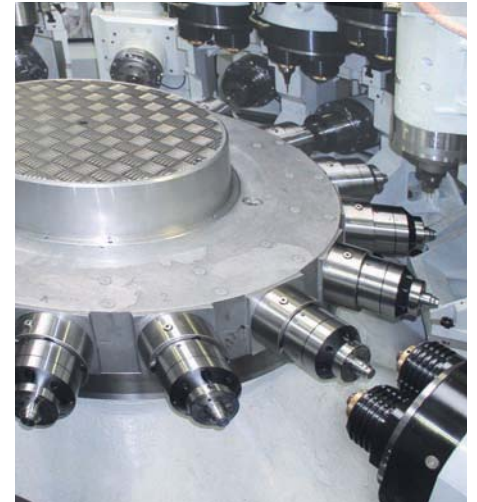
Testa a revolver con 3 mandrini con interfaccia HSK 40 e 2 servo-azionamenti, tempo di sostituzione da serraggio a serraggio < 1,5 sec., IKZ (alimentazione interna refrigerante) fino a 70 bar, numero di giri fino a 10 000 min -1 , disponibile anche come attacchi a 4 risp. 5 mandrini. Grazie alla forma compatta del tamburo si possono occupare anche le stazioni adiacenti!
