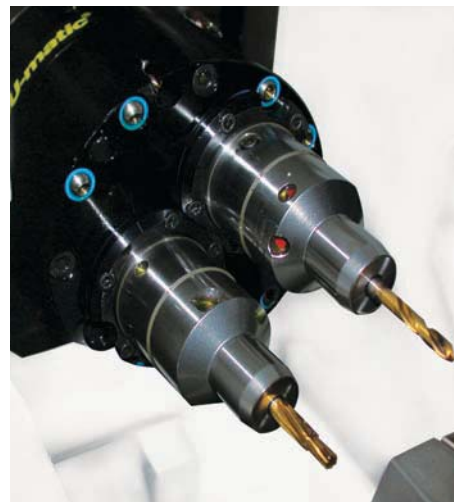
Testa a 2 mandrini con interfaccia HSK 40 / 50, IKZ (alimentazione interna refrigerante) fino a 70 bar, numero di giri fino a 10 000 min -1
