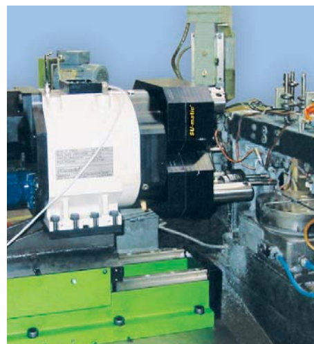
Dopo: macchina modificata con testa a revolver e due teste multiple; si ottiene un risparmio di tempo del > 42%
