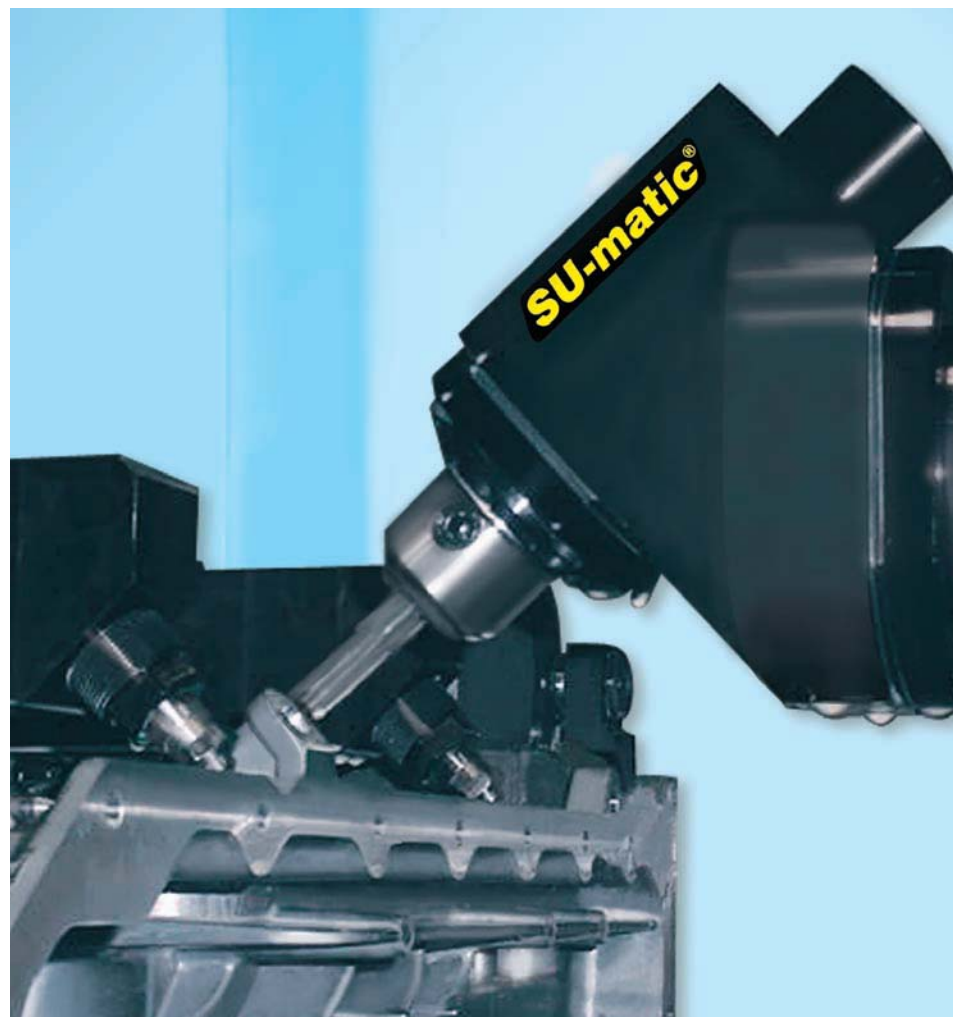
Lavorazione di coppe dell'olio, fori per astine misurazione olio in un unico serraggio
