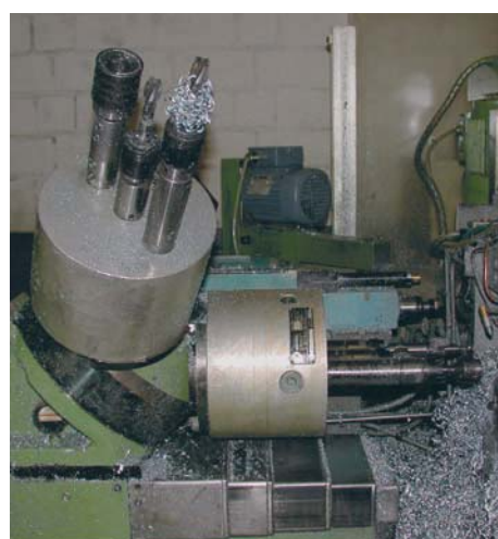
Prima: revolver a stella con due teste a 3 mandrini. Tempo di ciclo > 19 secondi
