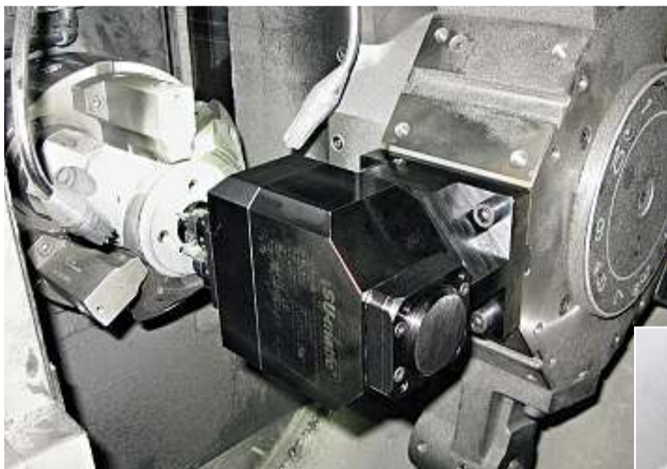
4fach Mehrspindelkopf mit 2 unterschiedlichen Bohrdurchmessern
