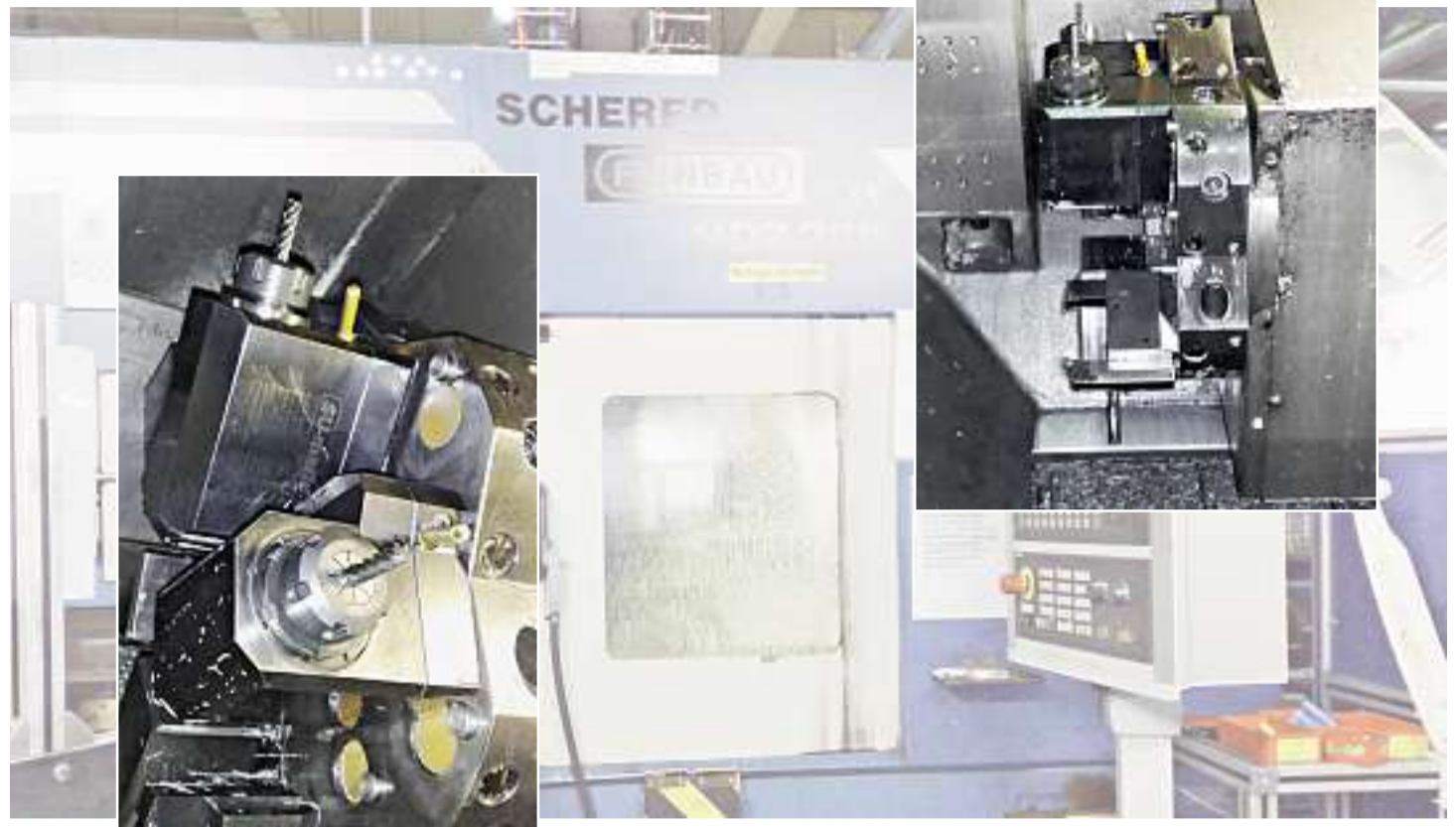
Offset-Winkelköpfe mit unterschiedlichen Arbeitswinkeln
