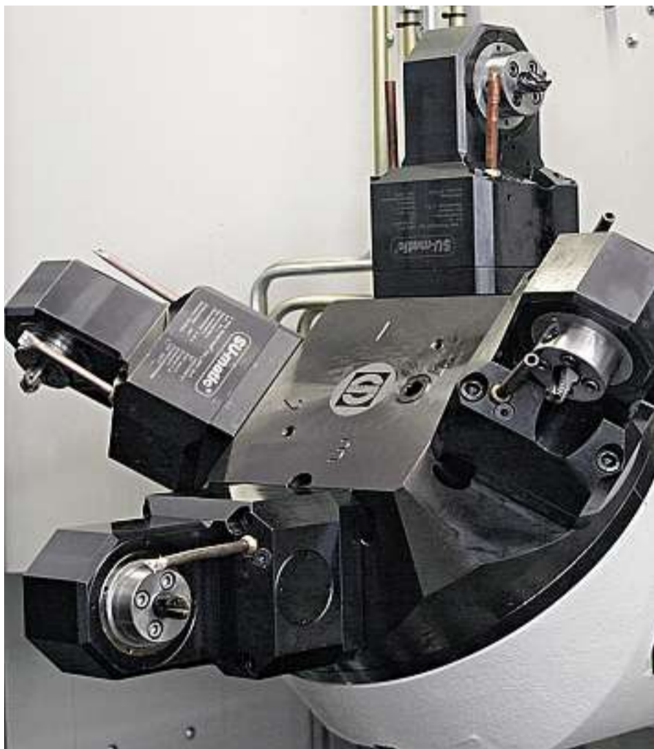
SU-matic Winkelköpfe auf 4fach Revolver
