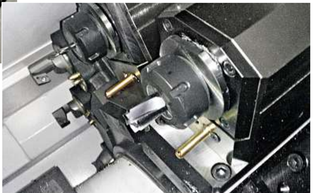
Angetriebene Halter für die neue OKUMA 2SP-250 H Baureihe
