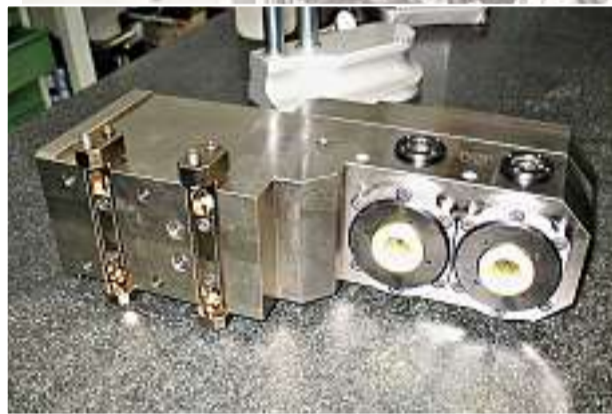
Angetriebene 2fach Axialeinheit mit Coromant Capto Schnittstelle C3
